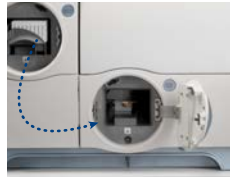
ローダーにセット （カードの培養および 各反応の読み取りを開始）
