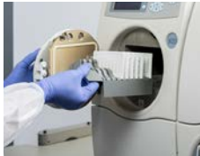
フィラーにセット （菌液をカードに充填）
